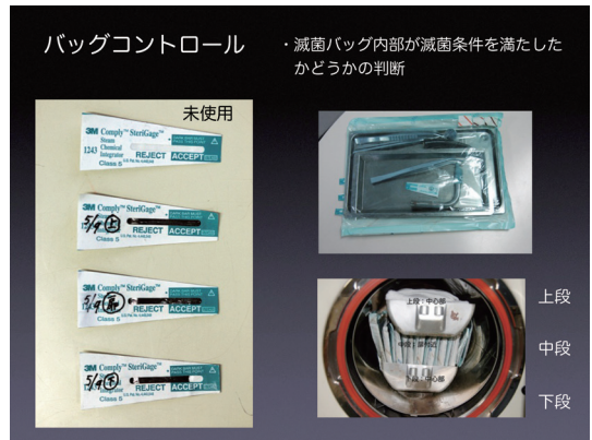
図2 オートクレーブの滅菌ごとに滅菌バッグ内にクラス5のインジケータを入れ、条件の悪そうな3箇所ですの都度モニタリングをしている。このような結果が出れば滅菌できていると判断した
