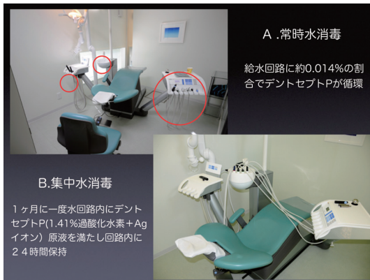
図14 集中水消毒システムだけでは時間の経過とともに細菌の繁殖が起こるといふ。ユニット使用中に常時消毒薬が滴下されている常時水消毒システムとの併用が必要のようだ
