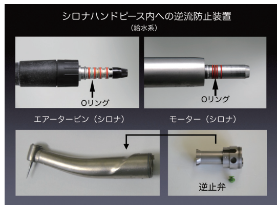
図7 各メーカーによって対応がまちまちのようだが、シロナ社はカップリング部のOリングとハンドピース内の逆止弁の2重の対策がとられている。メーカー側から、防止構造を2重にしておくことが重要だとの説明を受けた
