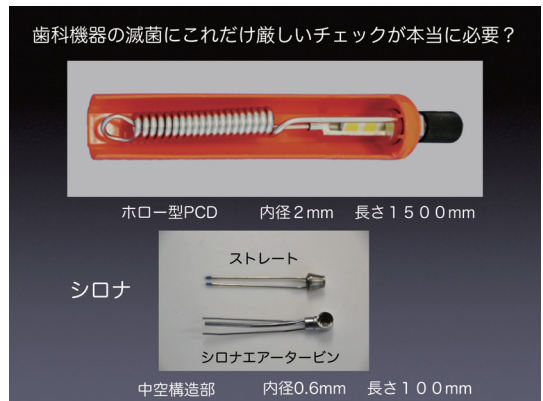
図4 このPCDは内径2mm長さ1,500mmの中空配管部分の先にインジケータの容器が配置されている。一方、ハンドピース類は内径0.6mm長さは約100mmである。比較すると中空部分の長さは15分の1になる
