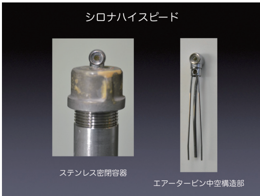
図5 ステンレス配管パイプの両端にエンドキャップをはめ、密閉容器を作成した。片方のエンドキャップに穴を空け、ハンドピースの中空配管部分が入りヘッド部分だけが外に出る位置関係で、耐熱エポキシで接着した
